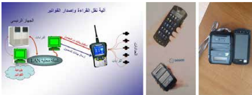
الشكل ٢ نظام المساعد الرقمي الشخصي المحمول بما في ذلك الطابعة المحمولة باليد
