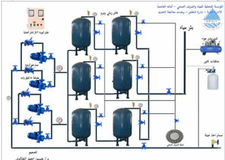
الشكل ٢٠ شكل تخطيطي لوحدة إزالة الحديد
